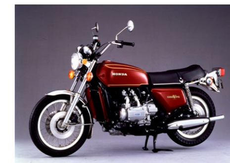
Pierwsza Honda Gold Wing była napędzana chłodzonym wodą, czterocylindrowym silnikiem o pojemności 999 cm 3 .
